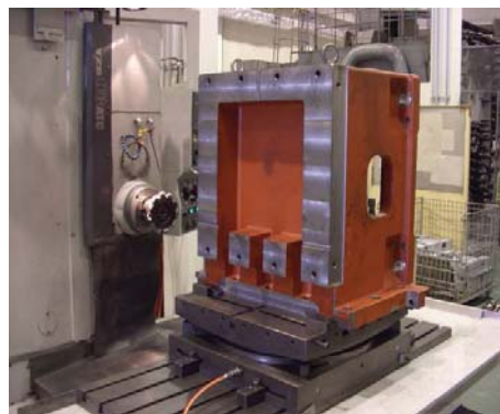
【最适用于搭载圆形工作台的箱形多面加工！】
